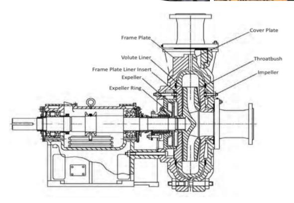
Las bombas de lodo CGIGZB(P) son bombas de lodos centrífugas horizontales en voladizo, de una sola etapa, de una sola succión, de doble carcasa y de alta altura de suministro.
